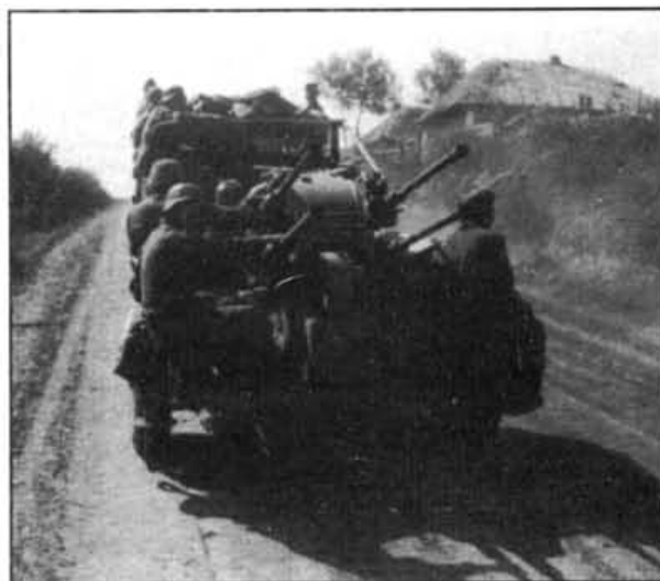
20-мм счетверенная зенитка буксируется грузовиком
