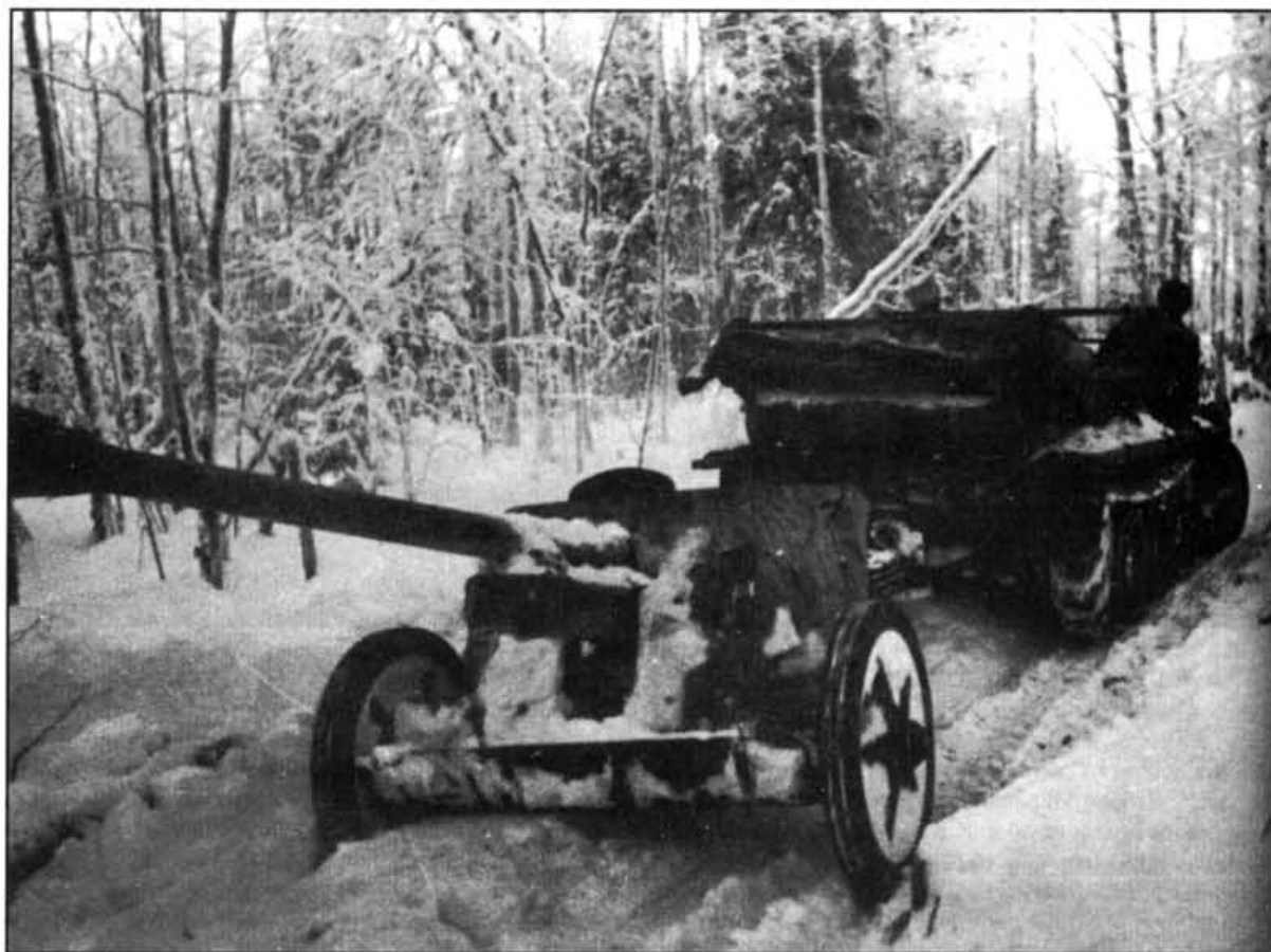
Полугусеничный тягач Sdkfz 10 буксирует 50-мм Pak 38 по заснеженному лесу Восточного фронта, 1941 г.
