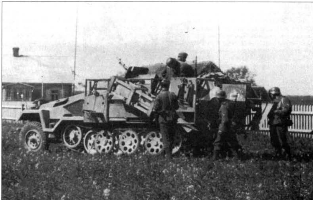
Направляющие для 280/320-мм реактивных снарядов смонтированы на бронетранспортере SdKfz 251
